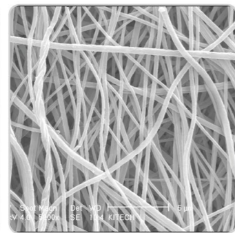
PVDF Main Media 섬유굵기 (Fiber diameter) : 0.2 ~ 0.3 μm 기공도 (Porosity) : 65 ~ 70%
